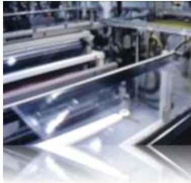
Sistema de coextrusión en 3 capas cabezal plano para películas de vacío de alta resistencia.
